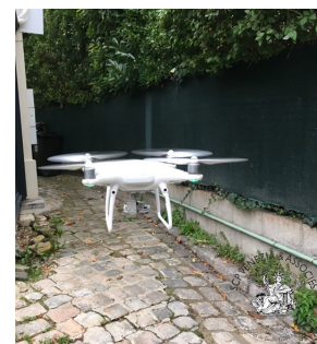
Photographie d'un drone utilisé pour la réalisation d'un constat de toiture en Octobre
